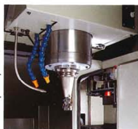
VS50-ATC 新開発のカム方式の採用により油圧レスATCを実現しました。
