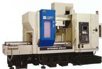
VS50-APC付 アーム動作にはモータを使用し、クランプにはエアで油圧を増圧するエア・ハイドロブースターを使っています。
